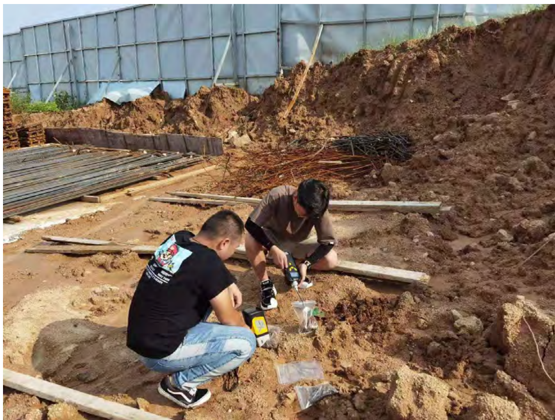
图 3-9 现场快筛照片 1
